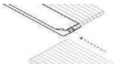
2. Dejar una separación para permitir dilatación de policarbonato (2.5 a 3 mm)
